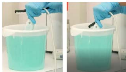
Hình 5-3 Vệ sinh đầu dò bằng bàn chải
