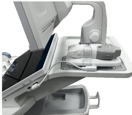
Hình 12-11 Đặt Vscan Air lên bộ sạc đầu dò
