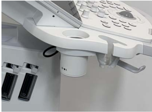
Hình 12-6 Máy làm ấm gel
