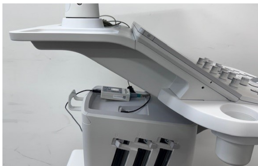
Hình 12-5 Kết nối bộ tiền khuếch đại ECG với đầu cắm USB-C người dùng có thể tiếp cận
