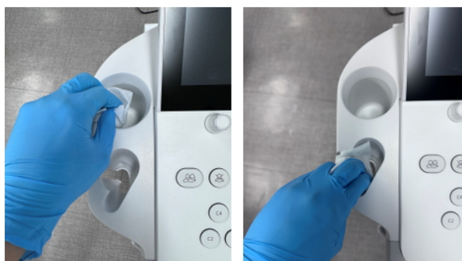
Hình 2-8 Vệ sinh và khử trùng giá giữ đầu dò trái/phải
