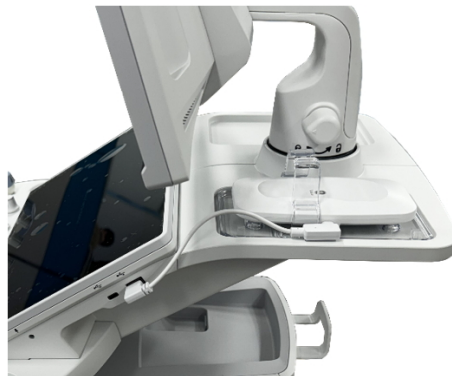
Hình 12-10 Kết nối cáp bộ sạc không dây R ở bên phải
